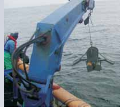
Biological sampling using a Van Veen Grab
